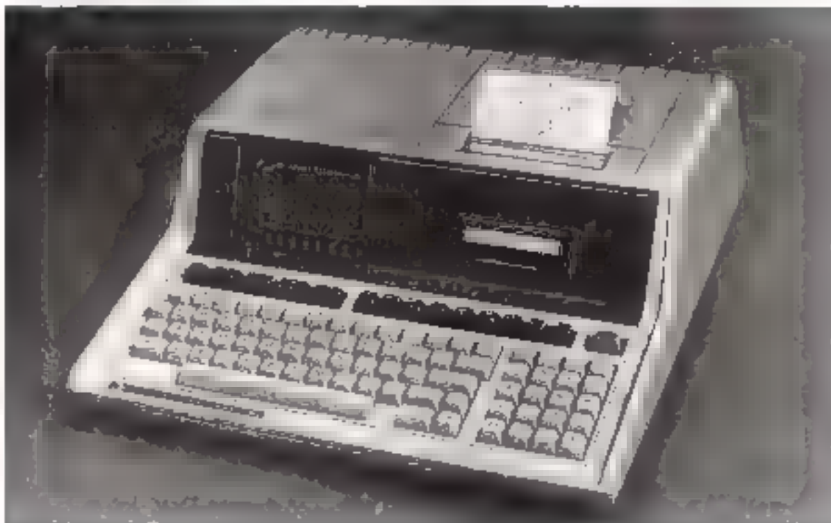
Le HP 85, un micro-ordinateur compact intégrant dans un même boîtier : l'unité centrale, le clavier, l'écran, l'imprimante et l'unité à bande magnétique.
